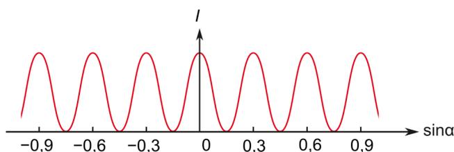
d) Skizze der Intensität nach dem Gitter. Die Intensität der Hauptmaxima wird durch den Doppelspaltstruktur der einzelnen Slitze moduliert.
