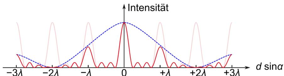
Die gestrichelte Kurve deutet die einhüllende Intensität des Einzelspalts an. Schattiert ist nochmals die Intensität gezeigt, wenn die Spaltbreite vernachlässigbar klein ist. (1 Punkt)
