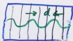
$$d = 1,5 \text{ cm}; \quad 1 \text{ cm} \equiv 0,2 \text{ ms} \Rightarrow \nu = 3,3 \text{ kHz}$$
