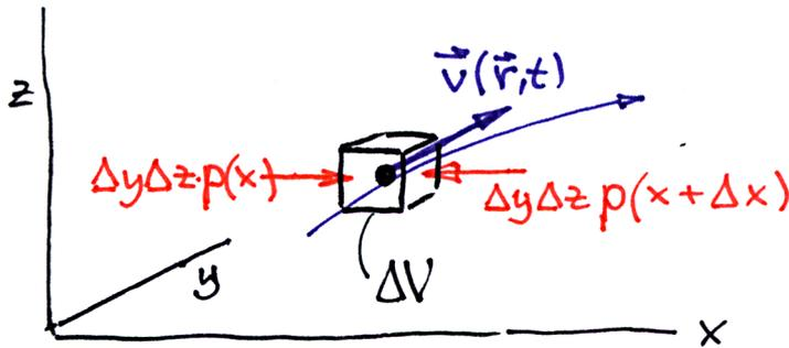
Beschleunigung des Massenelements  $\Delta m = \rho \Delta V$  durch interne Kräfte (Druck) und externe Kräfte (z.B. Schwerkraft)
