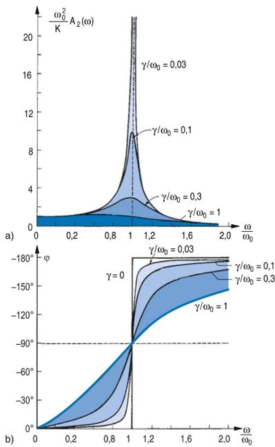
Abb. 11.23 a) Resonanzkurve der erzwungenen Schwingung für verschiedene Dämpfungen. Man beachte die Verschiebung des Maximums mit zunehmender Dämpfung. b) Quantitativer Verlauf der Phasenverschiebung
