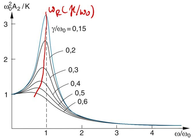
Abb. 11.24 Normierte Amplitude  $|A_2(\omega)|$  einer erzwungenen Schwingung
