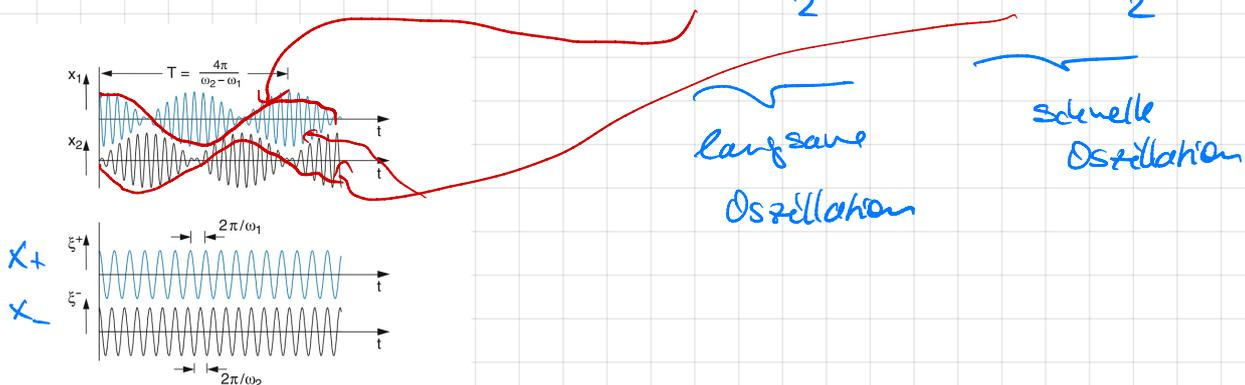
Abb. 11.29 Schwingungsamplituden  $x_1(t)$  und  $x_2(t)$  gekoppelter Oszillatoren mit der Schwebungsperiode  $T$  und die beiden Normalschwingungen  $\xi^+(t)$  und  $\xi^-(t)$
