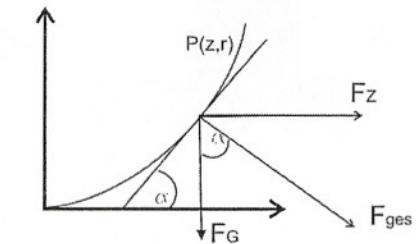
Im Gleichgewicht ( $P(z, r)$ ) in „Ruhe“ verschwindet die Tangentialkomponente
