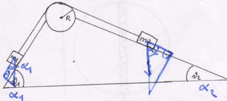
Zwei mit einem masselosen Seil über eine Rolle mit Trägheitsmoment  $I$  und Radius  $R$  verbundene Massen sind entsprechend der Abbildung angeordnet. Bestimmen Sie die Beschleunigungen der Massen  $m_1$  und  $m_2$ , wenn die Klötze reibungsfrei auf den Schrägen gleiten können.
