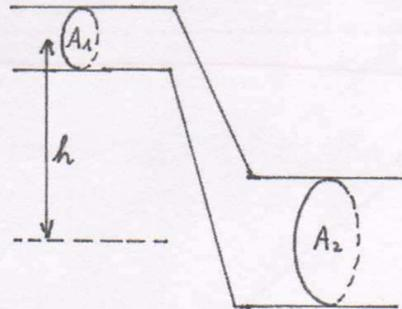
Wasser wird mit dem Massenstrom  $dm/dt$  durch ein horizontal liegendes Rohr mit dem Querschnitt  $A_1$  gepumpt, das sich auf den Querschnitt  $A_2$  erweitert. Das Wasser kann hier als ideale Flüssigkeit betrachtet werden. Rechnen Sie jeweils auch die Zahlenwerte aus.
