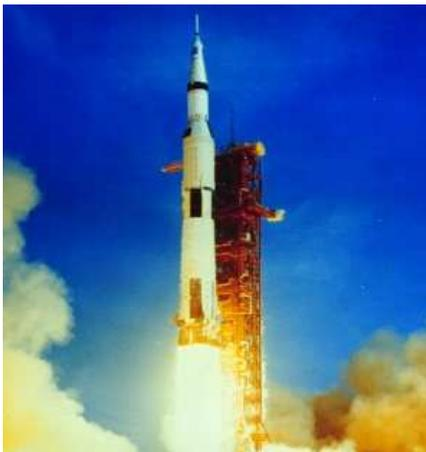
Der Brennstoff dieser Rakete besteht aus Kerosin und flüssigem Sauerstoff ( $O_2(l)$ ).
