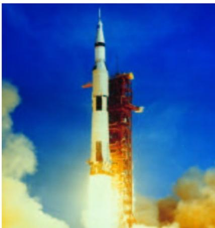
Der Brennstoff dieser Rakete besteht aus Kerosin und flüssigem Sauerstoff (O<sub>2</sub>(l)).
