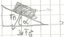
Überlegung: Ohne Reibung und Luftwiderstand müsste der Winkel  $90^\circ$  betragen, da somit Zentripetalkraft senkrecht auf der Bahn steht (stehen muss)
