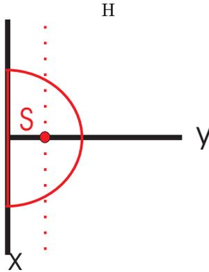
Abbildung 1: Schwerpunkt eines Halbkreises (Halbzylinder; Halbkugel)
