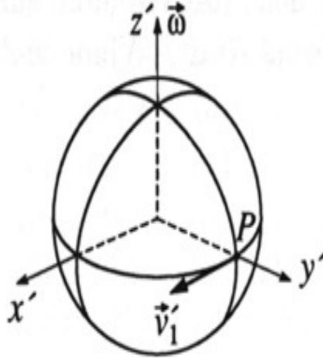
Im mitrotierenden Koordinatensystem (s. Bild; die Striche von  $\vec{v}, x, y, z$  sind der Übersichtlichkeit halber weggelassen) ist für einen Punkt mit der geographischen Breite  $\phi$ :  $\vec{\omega} = \omega\vec{k}$ ,  $\vec{g} = -g(\cos\phi\vec{j} + \sin\phi\vec{k})$ ,  $\vec{v}_0 = v_0(\cos\phi\vec{j} + \sin\phi\vec{k})$  (Anfangsgeschwindigkeiten) und allgemein:  $\vec{v} = v_x\vec{i} + v_y\vec{j} + v_z\vec{k}$ . Dies in (62) eingesetzt, liefert die drei Differentialgleichungen
