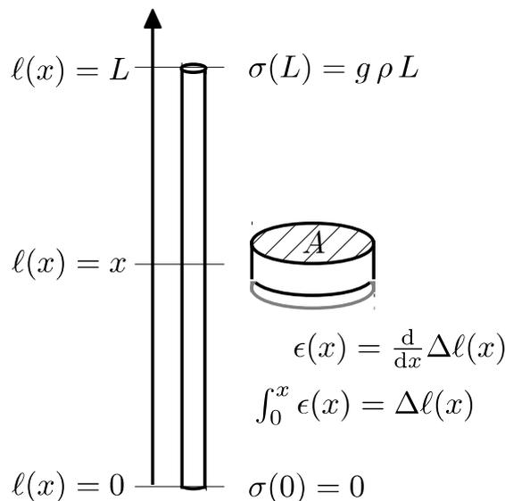
Um die Rechnung klarer zu machen haben wir die Länge des Seils als  $\ell(x) = x$  eingeführt. Für die Spannung des hängenden Seils unter seinem Eigengewicht gilt:
