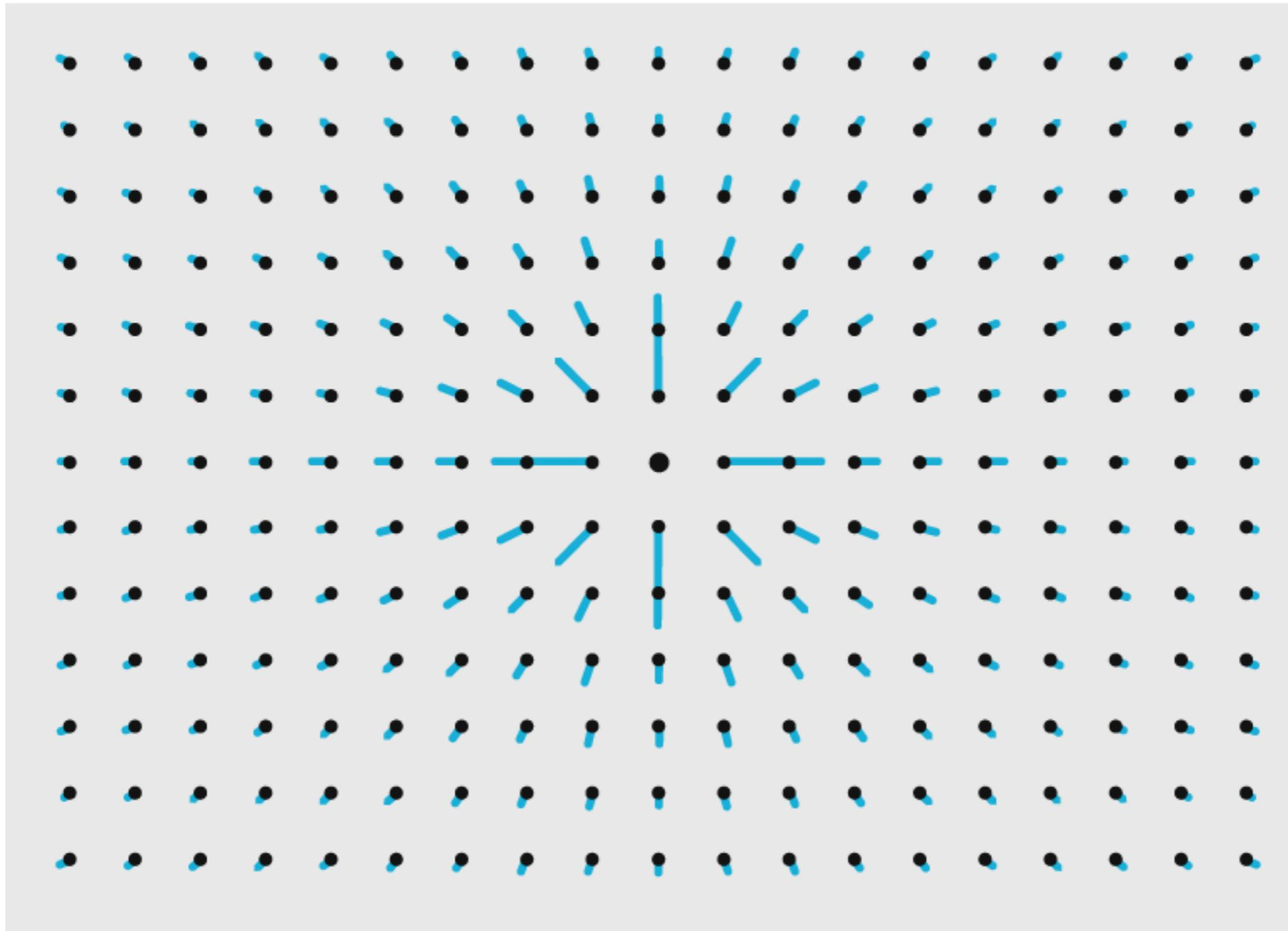
Abb. 6.5. Das Feld einer positiven Punktladung. Die Strichlängen stellen  $|E|$  dar. Die Feldlinien ergeben sich, wenn man solche Linienstücke zusammensetzt
