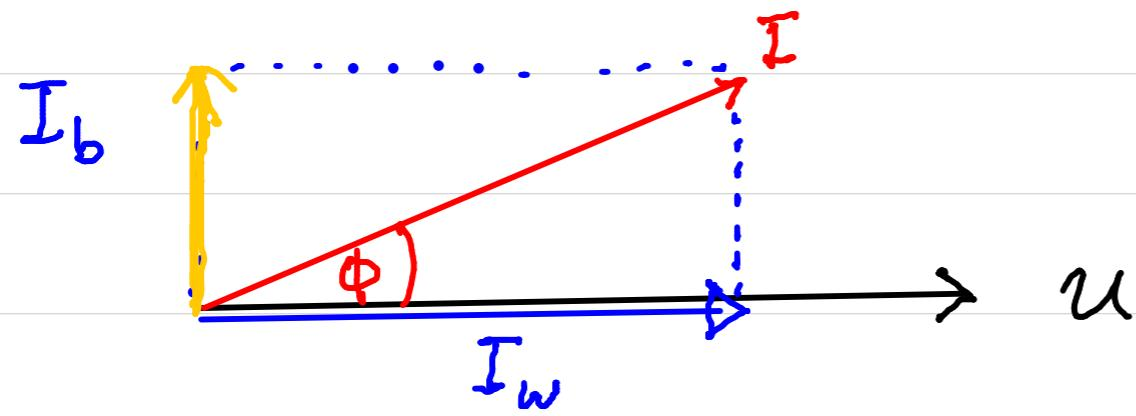
$$I_b \perp U \quad \text{Blindleistung}$$
