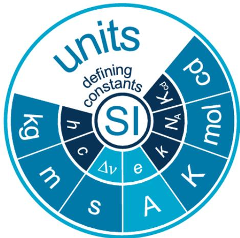
Das Ampere (Symbol A) ist die SI-Einheit der Stromstärke. Es wird definiert durch die Konstante der Elementarladung  $e$ . Der Zahlenwert dieser Konstante ist auf  $1,602\,176\,634 \cdot 10^{-19}$  festgelegt, wenn sie in der Einheit C bzw. A s angegeben wird und die Sekunde durch  $\Delta\nu$  definiert ist.
