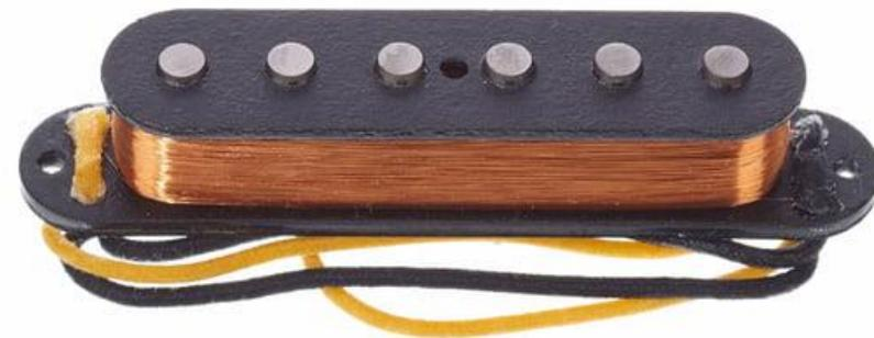
Bewegt sich eine magnetisierbare Saite mit relativer magnetischer Permeabilität  $\mu \gg 1$  im Magnetfeld des Permanentmagneten, so verändert die Saite zeitabhängig den magnetischen Fluss durch die Spule und eine Spannung wird induziert zwischen den beiden Enden der Spule.
