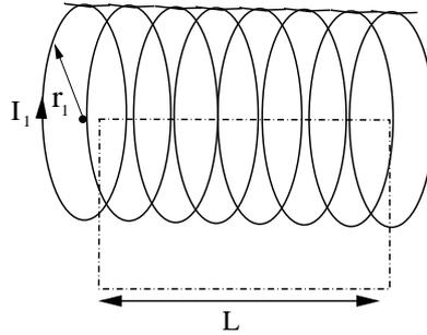
Die Abbildung zeigt ein Teil einer unendlich lange Spule mit Radius  $r_1$  und  $n$  Wicklungen pro Einheitslänge. Die Spule werde von einem Strom  $I_1$  durchflossen.
