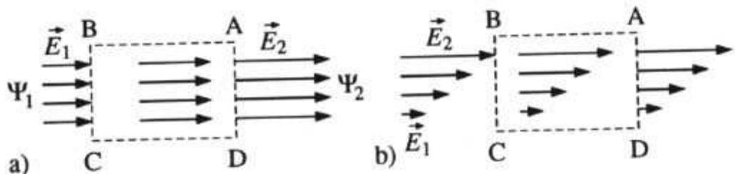
Beim Umlauf einer Probeladung  $q$  auf dem geschlossenen Weg A-B-C-D-A wird nur entlang A-B und C-D Arbeit geleistet. Dabei wird offensichtlich entlang des Weges A-B genau soviel Arbeit geleistet wie längs des Weges C-D wieder frei wird,
