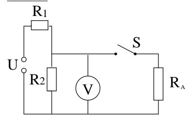
Der Widerstand R kann als Reihenschaltung von  $R_1 + R_2$  betrachtet werden. Bei geöffnetem Schalter S gilt:
