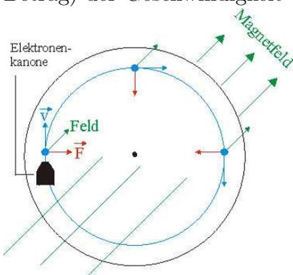
In der Abbildung sind für drei Stellen die Lorentzkräfte eingezeichnet. Es ist zu sehen, dass sie stets zum Mittelpunkt der Kreisbahn zeigen. Man bezeichnet die Lorentzkraft in diesem Fall auch als Zentripetalkraft. Sie ist dafür verantwortlich, dass die Elektronen auf einer Kreisbahn gehalten werden können. Beschleunigende Kraft wirkt hier ausschließlich Richtungsändernd.
