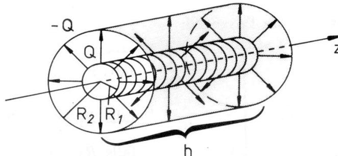
Die Anordnung besteht aus zwei koaxialen Zylindern der Höhe  $h$  mit den Radien  $R_1 < R_2$ . Das elektrische Feld  $\vec{E}$  verläuft axialsymmetrisch. Verwenden sie Zylinderkoordinaten mit dem Ansatz:  $\vec{E}(\vec{r}) = E(\rho) e_\rho$ .
