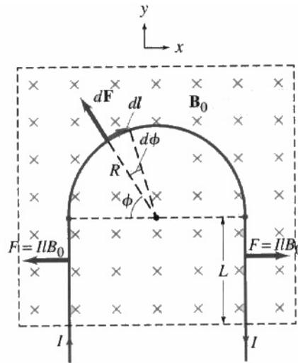
Die Kräfte auf den zwei geraden Zuleitungen sind gleich ( $= IlB_0$ ) und entgegengesetzt, deshalb heben sie sich auf. Folglich ergibt sich die resultierende Kraft aus dem halbrunden Teil. Wir teilen den Halbkreis in kurze Abschnitte  $dl = R d\Phi$  auf und verwenden die Gleichung  $d\mathbf{F} = I dl \times \mathbf{B}$ , so finden wir
