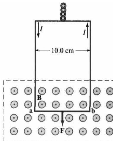
Die magnetischen Kräfte auf die zwei vertikalen Seiten der Leiterschleife sind entgegengerichtet. Da sie gleich groß sind, addieren sie sich zu Null. Die resultierende Kraft auf die Leiterschleife ist die auf die horizontale Seite  $ab$  mit Länge  $l = 0.1\text{ m}$  ( $\theta = 90^\circ$ )
