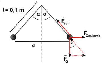
Somit wird laut dem Coulomb'schen Gesetz die Kraft zwischen den beiden gleich geladenen Kugeln (Ladung q) folgende sein:
