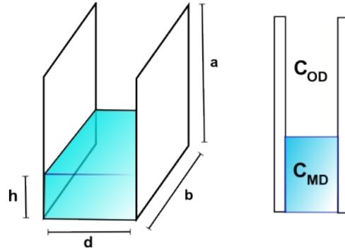
Wenn nun unten ein Dielektrikum hochsteigt, so haben wir eine Parallelschaltung von Plattenkondensatoren, wobei:
