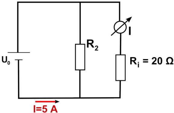
b) Nun bleibt unsere Stromstärke gleich ( $I = 1 mA$ ), wir sollen aber Spannungen von  $200 V$  messen können. Somit bauen wir vor den Strommesser einen großen Widerstand in Reihe, sodass dort eine große Spannung abfällt. Für den Gesamtwiderstand  $R_{Ges} = R_i + R_2$  muss gelten:
