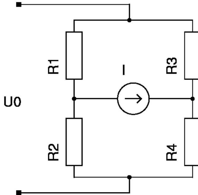
Bei 3 variablen Widerständen werden diese so eingestellt, dass der Spannungsmesser in der Mitte keine Spannung zwischen  $R_{12}$  und  $R_{34}$  anzeigt. Somit kann der vierte Widerstand beliebig genau gemessen werden, denn bei einer angezeigten Spannung von 0 erhält man gerade:
