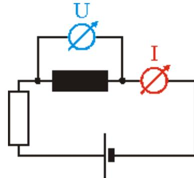
Abbildung 3: Spannungsrichtige Schaltung, Spannung wird direkt am Widerstand gemessen
