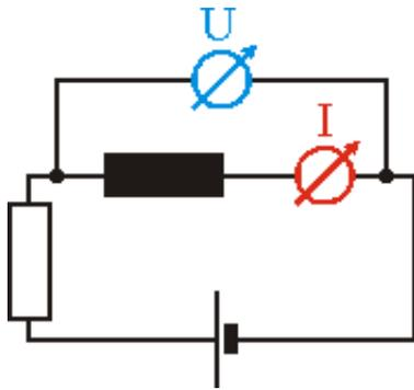
Abbildung 2: Stromrichtige Schaltung, Strom wird direkt am Widerstand gemessen
