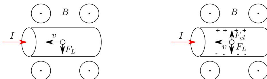
(a) Die Elektronen im Leiter werden durch die Lorentzkraft abgelenkt. Dadurch entsteht im Leiter ein elektrisches Feld. Wenn die Lorentzkraft betragsmäßig genauso groß wie die Kraft des elektrischen Felds ist, durchlaufen die Elektronen den Leiter wieder geradlinig. Das elektrische Feld bleibt aber bestehen und wird als die Hall-Spannung gemessen.
