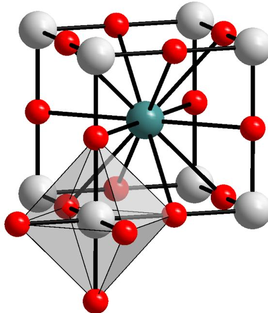
An den Ecken befinden sich graue Titanionen und an den Kanten rote Sauerstoffionen. In der Mitte jeweils ein Bariumatom. Unter  $T_C = 118^\circ C$  verschieben sich die Titanmoleküle in Richtung der  $z$ -Achse und eine Elementarzelle besitzt einen Dipol.
