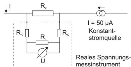
Berechnen Sie zunächst die Spannung, die ein ideales Messinstrument ( $R_i = \infty$ ,  $R_k = 0$ ) messen würde. Welche Spannung wird dagegen bei dem realen Messinstrument abgelesen? Wie groß ist der relative Fehler bezogen auf den Idealfall?
