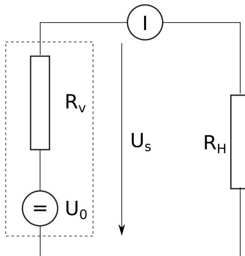
In der Aufgabe soll eine ideale Spannungsquelle mit vorgeschaltetem Widerstand mit und ohne Last behandelt werden.
