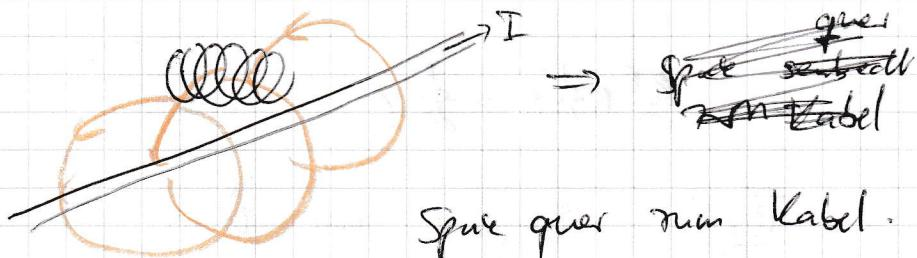
c)  $V_{\text{ind}} = \dot{\phi} = N A \dot{B} \quad \dot{B} = \frac{\mu_0 I_0}{2\pi r} \cdot \omega I_0 \cos(\omega t)$
