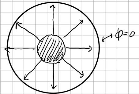
Für den geerdeten Innenleiter wird durch den Außenleiter auch ein Feld außerhalb des Außenleiters erzeugt. Durch das zusätzliche Feld erhöht sich die Kapazität des Leiters um die Selbstkapazität des Außenleiters, was in der Anwendung ein unerwünschter Effekt ist.
