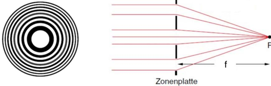
Bei Beleuchtung mit parallelem Licht der Wellenlänge  $\lambda$  ist die Brennweite  $f$  der Zonenplatte gegeben durch den Radius  $\rho_1$  der zentralen Öffnung (oder Scheibe),
