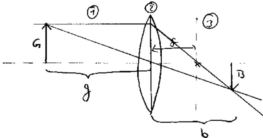
$$\begin{pmatrix} G \\ \varphi_g \end{pmatrix} \rightarrow \begin{pmatrix} B \\ \varphi_b \end{pmatrix}$$
