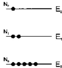
im therm. Gleichw:  $\frac{N_1}{N_0} = e^{-\frac{\Delta E}{kT}} \quad \frac{N_2}{N_1} = e^{-\frac{\Delta E}{kT}} \quad \text{hier } \Delta E = \text{const.} = kT$
