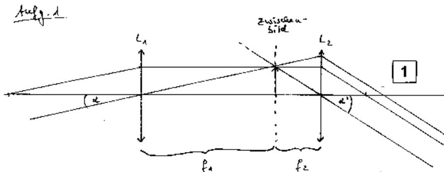
Das Kepler-Fernrohr besteht aus zwei konvergenz Linse  $L_1$  und  $L_2$  mit den Brennweiten  $f_1$  und  $f_2$  im Abstand  $d = f_1 + f_2$ . 1
