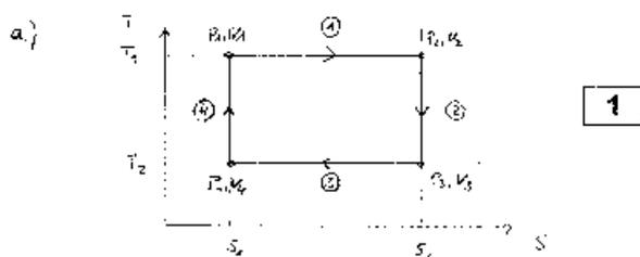
① isotherme Expansion: Gas wird im Wärmebad  $T_1$  expandiert. 0,5
