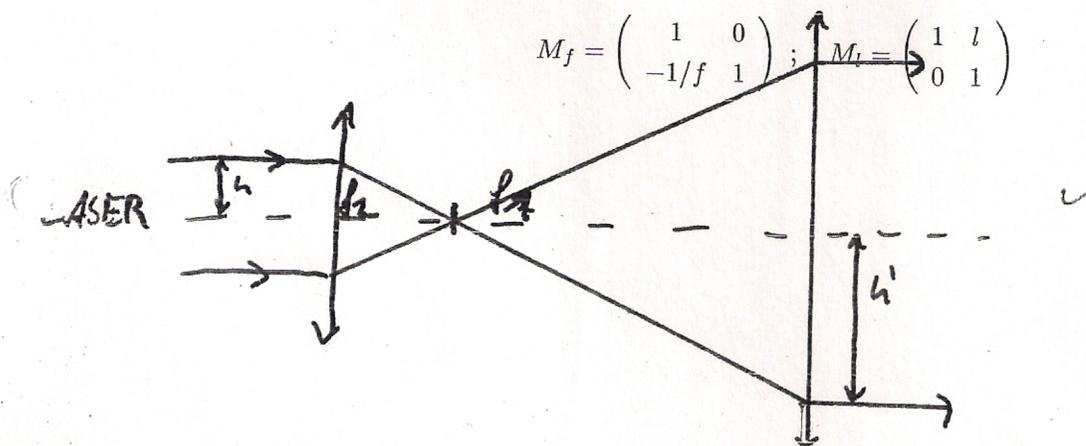
Zur Vergrößerung von achsenparallelen Strahlen muss die Brennweite der ersten Linse kleiner, als die der zweiten sein: ~
