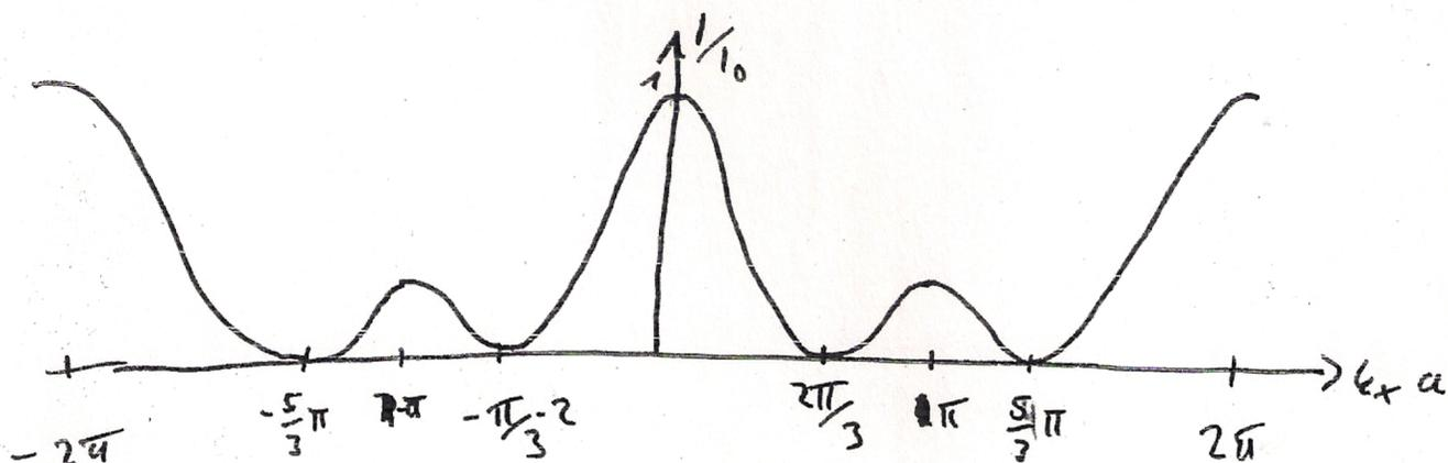
⇒ mit Phasenplatte sind die großen Maxima bei ungeraden Vielfachen von  $\pi$ , die kleineren bei geraden Vielfachen von  $\pi$  und die Nullstellen bei  $\frac{\pi}{3} + 2k\pi, -\frac{\pi}{3} - 2k\pi, k \in \mathbb{Z}$ .
