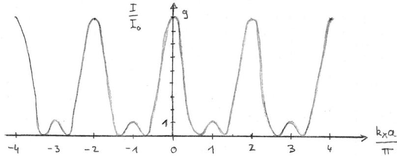
b) Phasenverschiebung um  $180^\circ$  im zentralen Spalt
