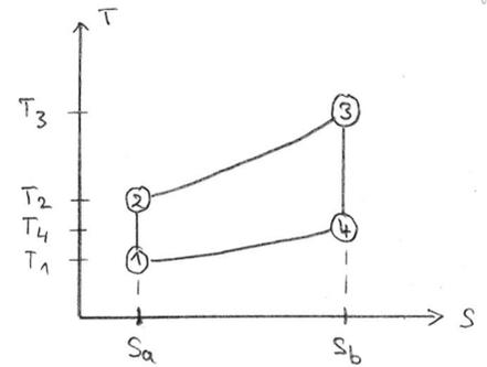
b) bei isentropen Kompression oder Expansion gilt  $dU = \delta Q + \delta W \rightarrow dU = \delta W \rightarrow W = n c_v \Delta T$  ( $\Delta Q = 0$ )
