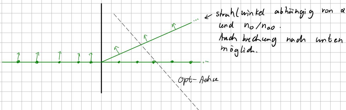
Indem man den Kristall so formt, dass der außerordentliche Strahl an einer anderen Seite austritt als der ordentliche Strahl, kann einen Polarisations-unterscheidenden Strahlteiler zu bauen. Wie z.B. in einem Glan-Thompson-Polarisator
