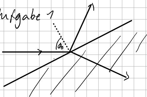
a.) Der Brewster-Winkel ist der Winkel bei dem der zur Oberfläche parallel polarisierte Anteil einer Welle nicht reflektiert wird. Der Reflektierte Lichtstrahl ist linear polarisiert!
