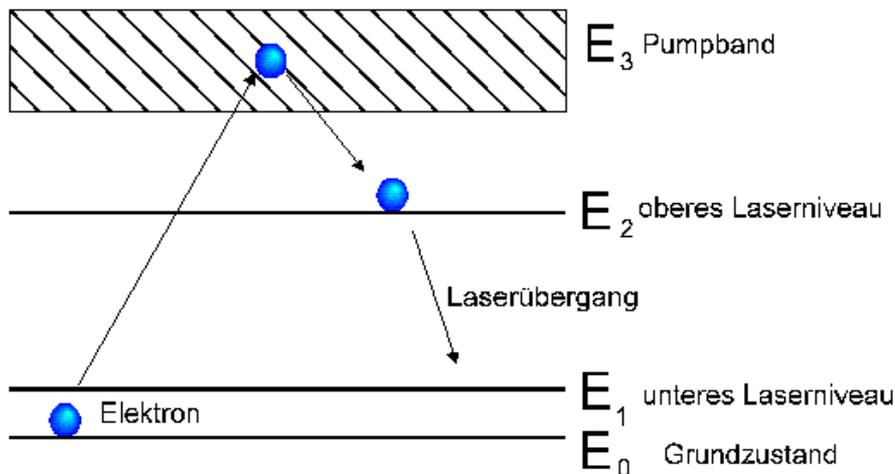
Um die Elektronen in einen angeregten Zustand zu bringen, muß der Laser "gepumpt" werden. Dies kann z.B. durch Gasentladung, Licht oder anderen Laser geschehen.
