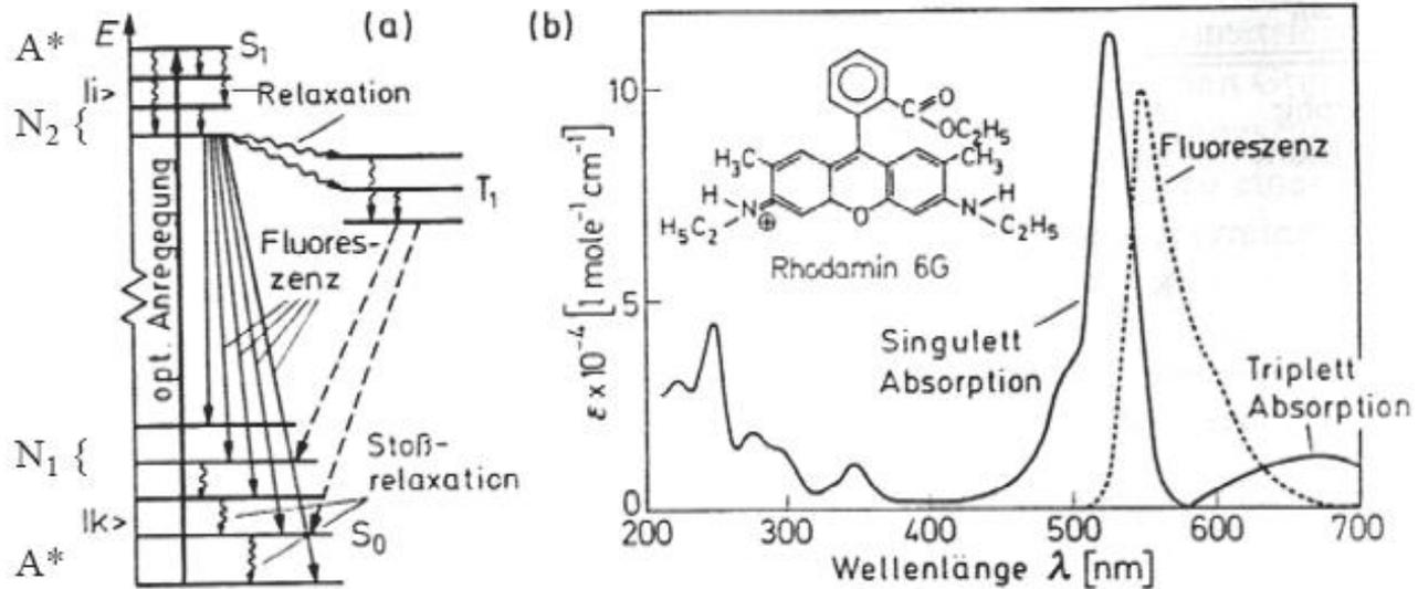
Abb. 5.60. (a) Vereinfacht dargestelltes Termschema eines Farbstofflasers und (b) Struktur, Absorptions- und Emissionsspektrum von Rhodamin 6G in Äthanol gelöst = 4-Niveau-System
