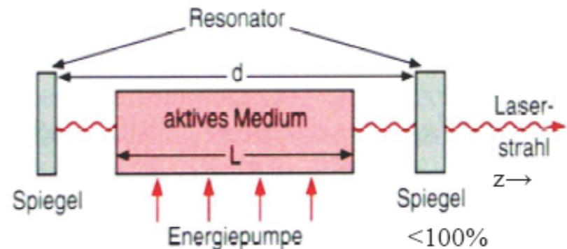
Abb. 8.1. Aufbauprinzip eines Lasers
