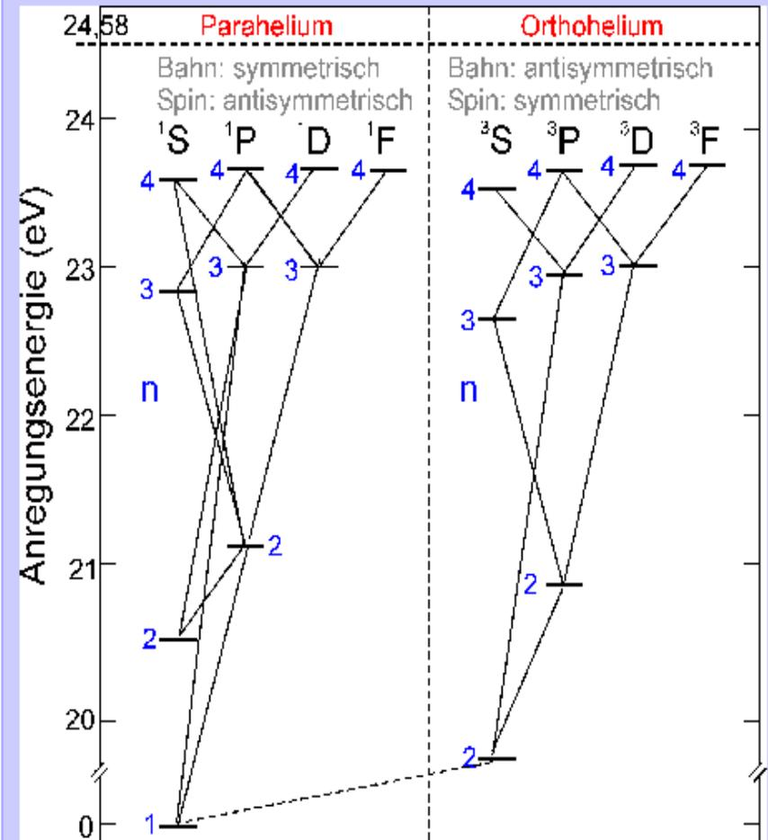
Ein Elektron sitzt in 1S. Die Quantenzahlen geben Gesamtbahnimpuls und Gesamtspin wieder. Die Linien des Ortho-Helium sind wegen  $S=1$  und der Spin-Bahn-Wechselwirkung Triplets.
