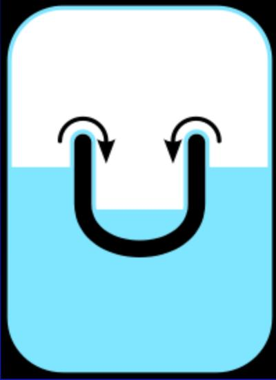
Helium II „kriecht“ an der Wand des inneren Gefäßes hoch – nach einer gewissen Zeit würden sich die Flüssigkeitsstände in den Behältern angleichen. Der *Rollin-Film* bedeckt auch die Wand des großen Behälters, wäre er nicht geschlossen, so würde der Flüssigkeitsfilm durch jede Öffnung kriechen und so das Helium nach und nach entweichen.
