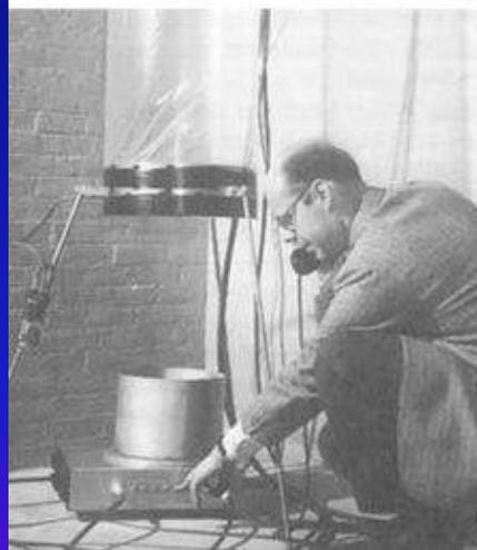
**Pound und Repka benutzten die Schärfe der Mössbauer Linien um die sehr kleine Rotverschiebung der Photonen im Gravitationsfeld ( $\Delta\nu/\nu \approx 10^{-15}$ ) in 1959 nachzuweisen durch den Abstand zwischen Quelle und Eisenabsorber bis zu 22 m zu variieren.**
