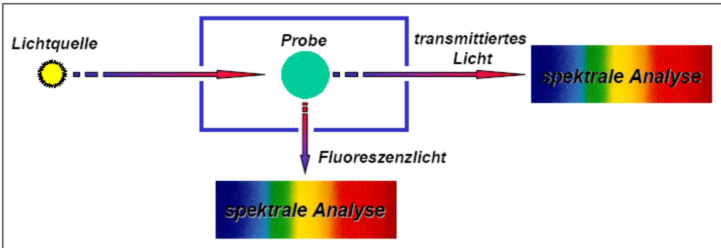
Jeder Absorptionslinie (Wellenlänge) entspricht auch eine Emissionslinie
