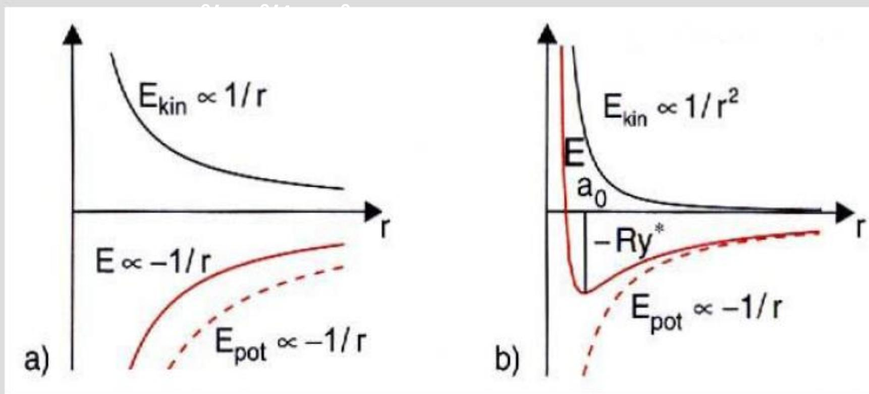
Verlauf von kinetischer, potentieller und Gesamtenergie des Elektrons im Coulombfeld des Kerns als Funktion des Abstandes  $r$  zwischen Elektron und Kern: (a) klassisch, (b) quantenmechanisches Modell
