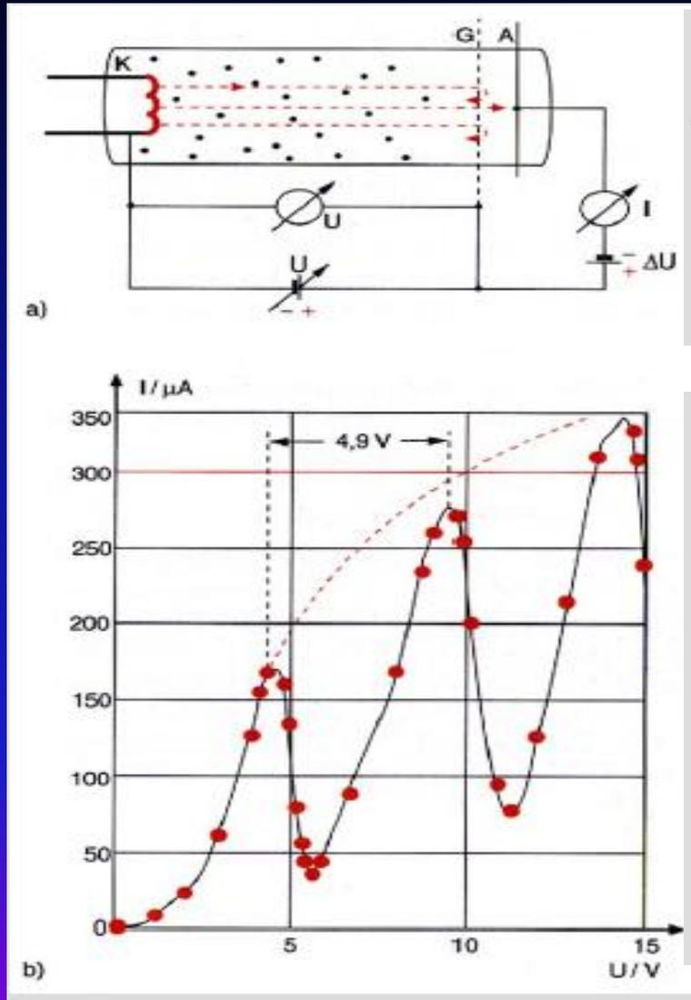
**Franck-Hertz-Versuch. (a) Experimentelle Anordnung. (b) Verlauf des Elektronenstroms  $I_e(U)$  als Funktion der Beschleunigungsspannung in einer Röhre mit Quecksilberdampf.**
