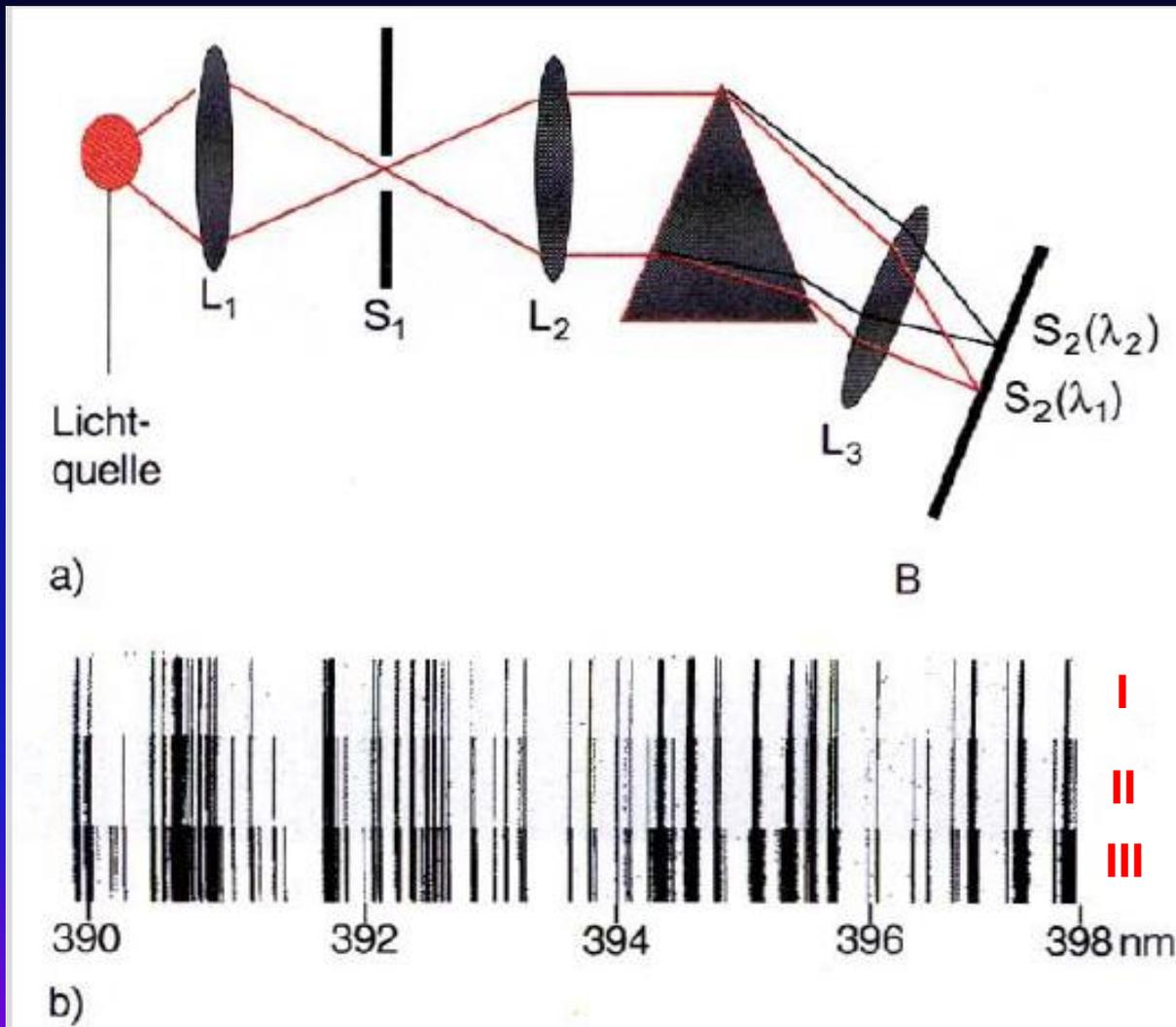
(a) Anordnung zur Aufnahme von Emissionsspektren mit einem Prismenspektrographen; (b) Emissionsspektrum eines Eisenbogens im Spektralbereich von 390 bis 398 nm mit drei verschiedenen Belichtungszeiten.
