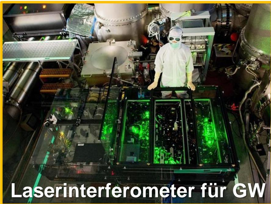
**Laserinterferometer für GW**
