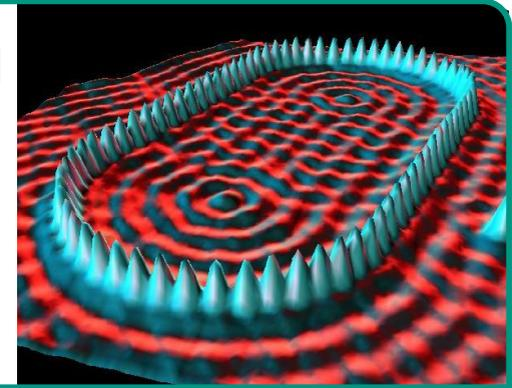
Ring aus 48 Fe-Atomen positioniert auf Cu(111) Oberfläche bei  $T = 4$  K
