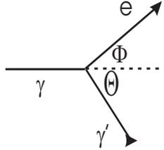
$E_{kin} = E_\gamma - E'_\gamma = \frac{hc}{\lambda} - \frac{hc}{\lambda'} = hc \frac{\lambda' - \lambda}{\lambda\lambda'}$  mit  $E_\gamma = \frac{hc}{\lambda}$  und  $E' = \frac{hc}{\lambda'}$  folgt aus der Comptonformel:
