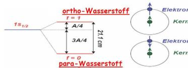
Abbildung 1: Ortho- und Para-Wasserstoff
