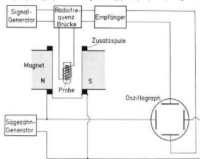
Abb. 20.18. Schema einer einfachen Kernspin-Resonanz-Apparatur. Die Probe befindet sich im Reagenzglas zwischen den Polshuhen eines homogenen Magneten. Das hochfrequente  $B_1$ -Feld wird über eine Brücke und eine Induktionsspule eingestrahlt. Zum besseren Nachweis der Resonanz kann das  $B_0$ -Feld durch eine Zusatzspule moduliert werden
