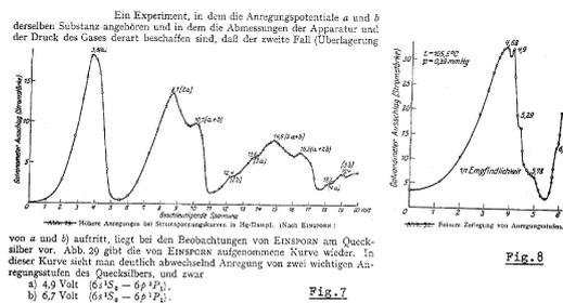
Abbildung 2: Franck-Hertz-Kurve die Substrukturen zeigen die höheren Anregungszustände
