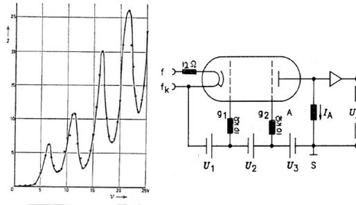
Abbildung 1: Franck-Hertz-Kurve und Franck-Hertz Versuchsanordnung
