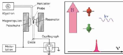
Abbildung 56: Schematische Darstellung des Versuchs. Die Spannung an den Spulen des Modulationsfeldes wird an die  $x$ -Ablenkung und das Signal der Diode an die  $y$ -Ablenkung eines Oszillographen gelegt. Im Falle der Resonanz nimmt das Signal in der Diode ab, da dem Feld Energie entzogen wird. Aus Haken Wolf, Atomphysik
