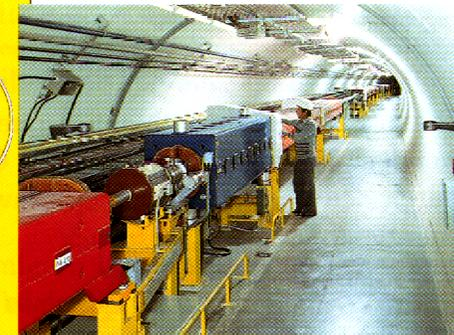
Abbildung 4.17: Links: Synchrotron (schematisch). Beschleunigungseinheiten, Dipolmagnete (Biegemagnete) und Quadrupole folgen aufeinander. Rechts: Das Super-Proton-Synchrotron (SPS) des CERN.
