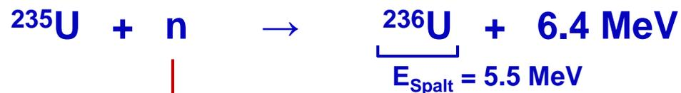
$E_n$  thermisch ausreichend, um  $^{235}\text{U}$  zu spalten ⚡  $\Rightarrow$  Kernkraftwerk
